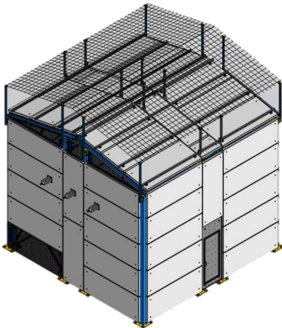
Рис. 1 - 3D модель сооружения комплексной защиты от внешних воздействий по разработке компании ООО «ЭЛПРО»
