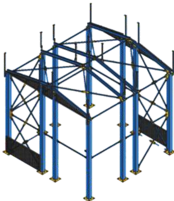
Рис. 2 – Металлокаркас защитного сооружения
